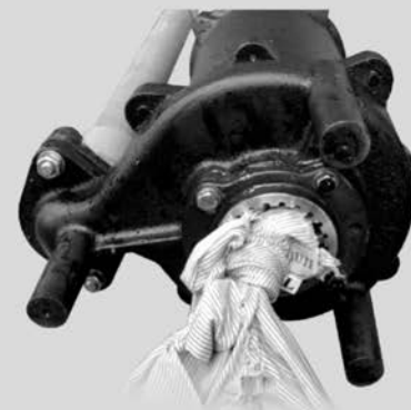
Ukázka řezacích schopností čerpadel řady GF
